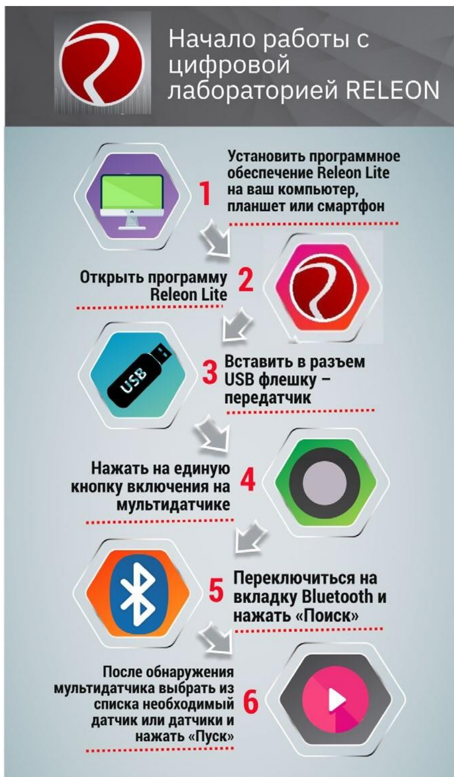
Рис. 14. Алгоритм работы с программным обеспечением Releon Lite
